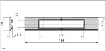
► Pour le montage dans le profilé de guidage de câbles 40x120x120 et 120x120 6N
