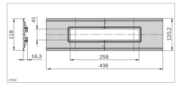
► Pour le montage dans le profilé de guidage de câbles 60x120 et 120x120
