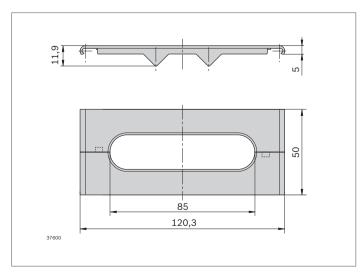
► Pour le montage dans le profilé de guidage de câbles 60x120 et 120x120
