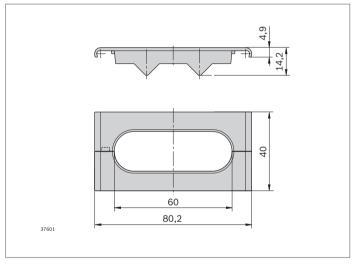
► Pour le montage dans le profilé de guidage de câbles 40x120x120 et 120x120 6N
