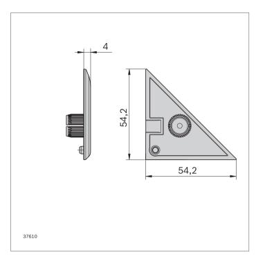
▶ Pour jonction de profilé d'angle 40x120x120 et joint profilé ou plaque de base 40x120x120
