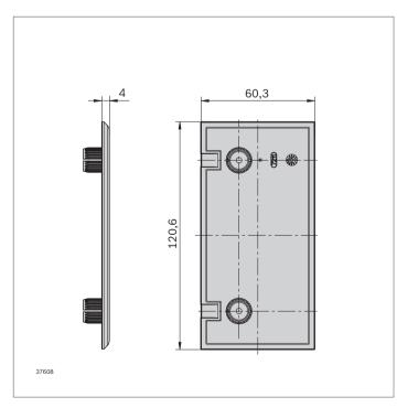
▶ Pour le joint profilé 3/4 ou 1/2 en lien avec le profilé de guidage de câble 60x120 ou plaque de base 60x120
